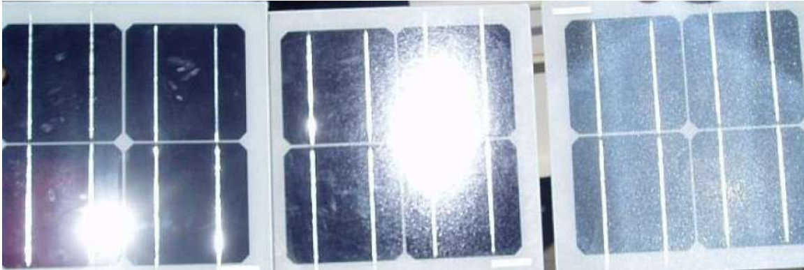
Bild 3.2.3: Diffuse Reflexion von unterschiedlichen Moduloberflächen (Quelle: Sandia National Laboratories, Ausschnitt)
